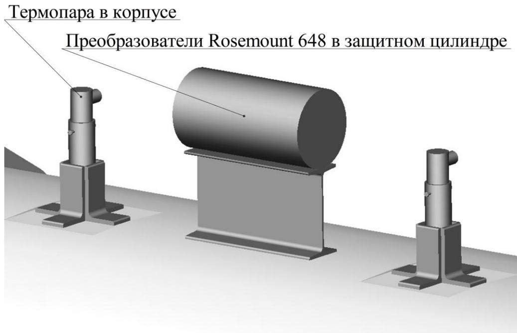
Рисунок А.3 – Конструкция крепления термопар и преобразователей
