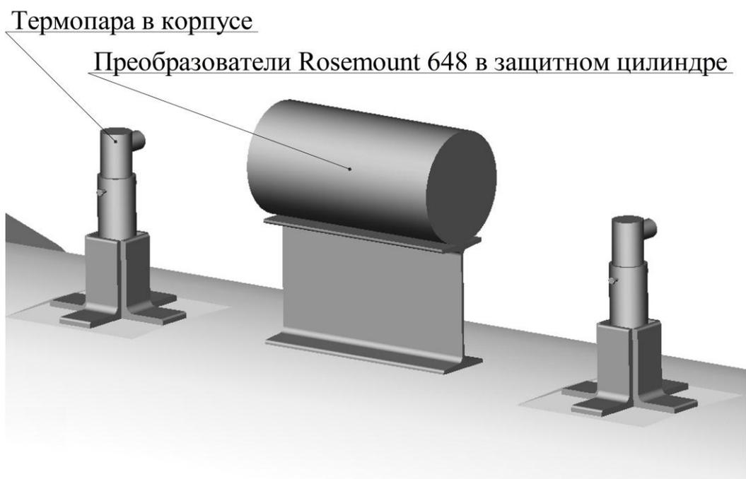
Рисунок 4.36 – Конструкция крепления термопар и преобразователей Rosemount 648 на вращающейся печи
