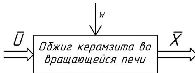
Рисунок 2.2 – Обобщённая структура процесса обжига как многомерного объекта управления
