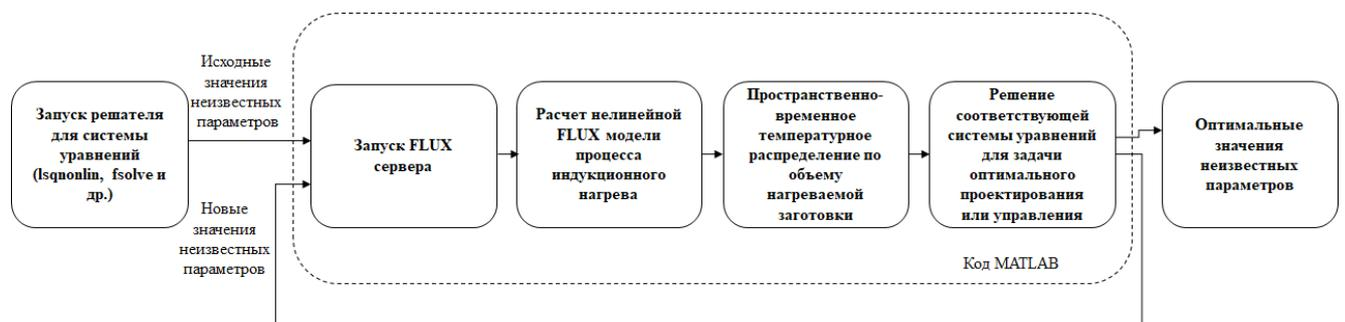
Рисунок 3.20 - Схема процедуры оптимизации, основанной на совместном использовании пакетов FLUX и MATLAB
