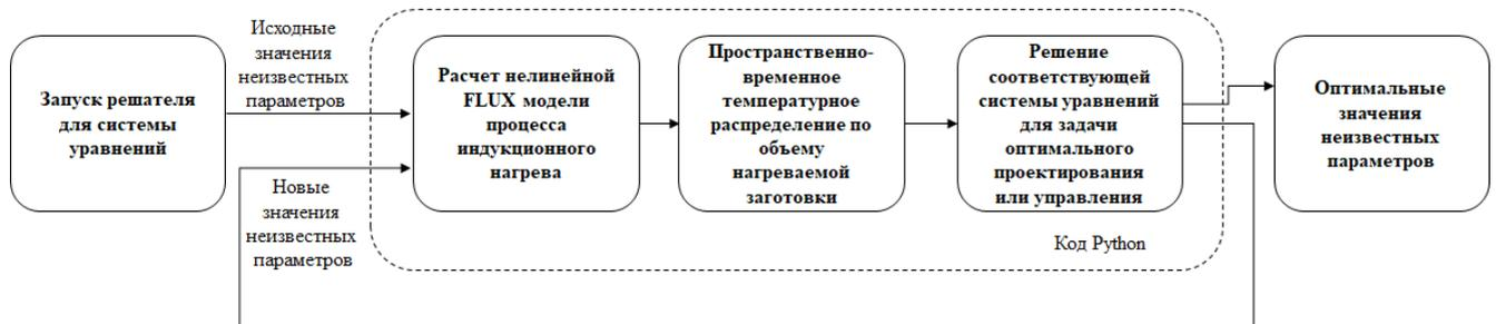
Рисунок 3.19 – Схема процедуры оптимизации, основанной на совместном использовании пакетов FLUX и Python
