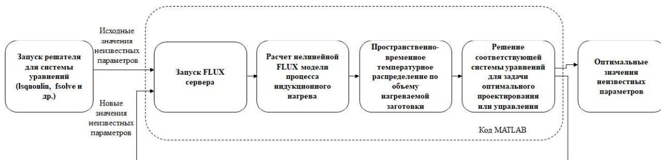
Рисунок 6 - Автоматизированная процедура оптимизации, основанная на совместном использовании пакетов FLUX и Matlab
