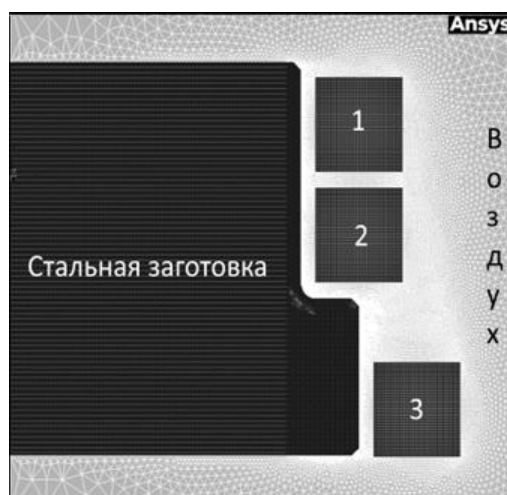
Рисунок 2.13 – Двумерная осесимметричная модель системы «индуктор – заготовка» с наложенной конечно-элементной сеткой в ППП ANSYS Mechanical APDL [26]
