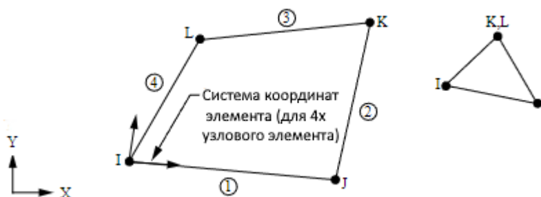
Рисунок 2.10 – Схематичное изображение конечного элемента типа PLANE13
