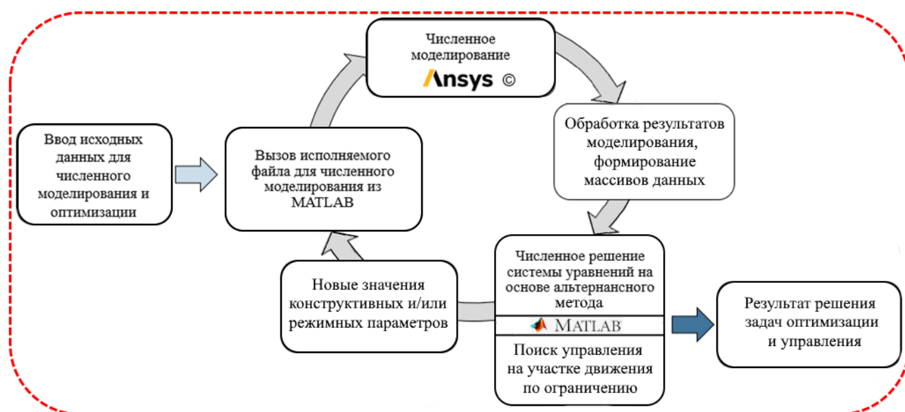
Рисунок 4.1 – Общая схема численных оптимизационных процедур в программном комплексе
