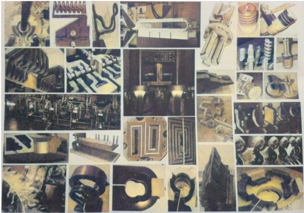
Рисунок 1.2 – Разновидности катушек индукционных нагревательных установок [35]
