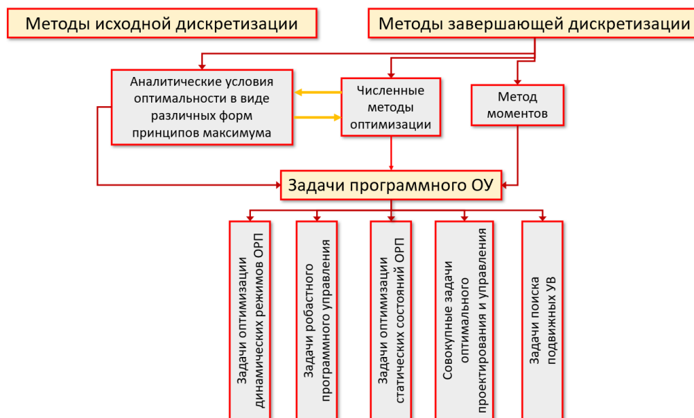
Рисунок 1.11 – Основные методы оптимизации электротехнологических систем с распределенными параметрами [10]
