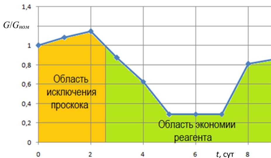
Рисунок 4.11 – Зависимость расхода щелочи, подаваемой для нейтрализации сероводорода, от времени
