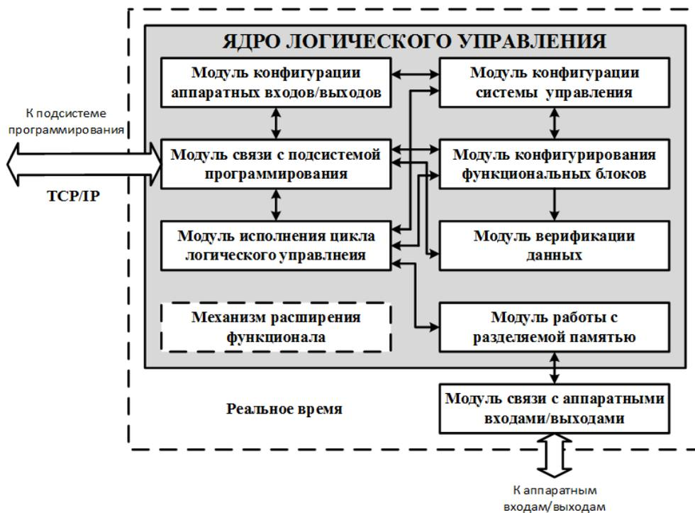
Рисунок 10 - Модули системного ядра логического управления
